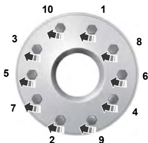
10-lug nut torque sequence
