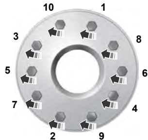
10-lug nut torque sequence
