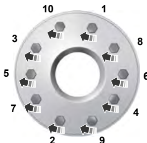
10-lug nut torque sequence
