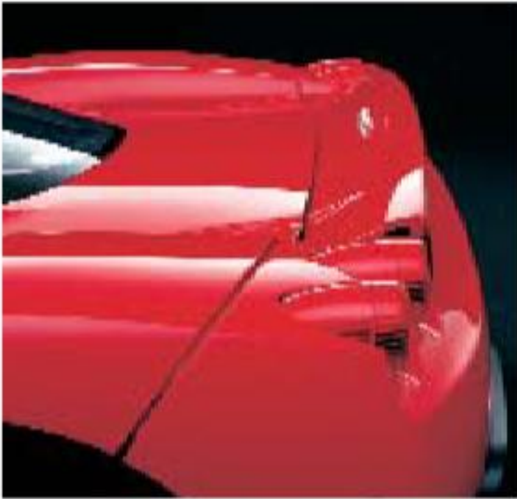
Lo spoiler mobile con una corsa di 75 mm, consente di regolare in maniera ottimale il carico posteriore nel range delle alte/altissime velocità
