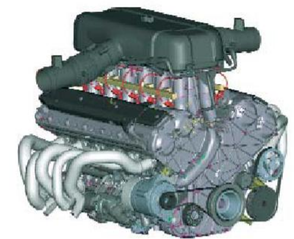
Immagine 3D del nuovo motore V12 che porta il numero di progetto F140
