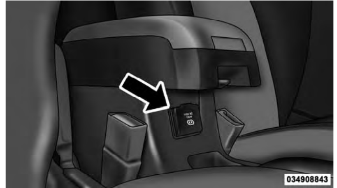
115 Volt Power Outlet
