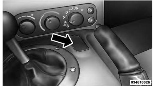
12 Volt Power Outlet
