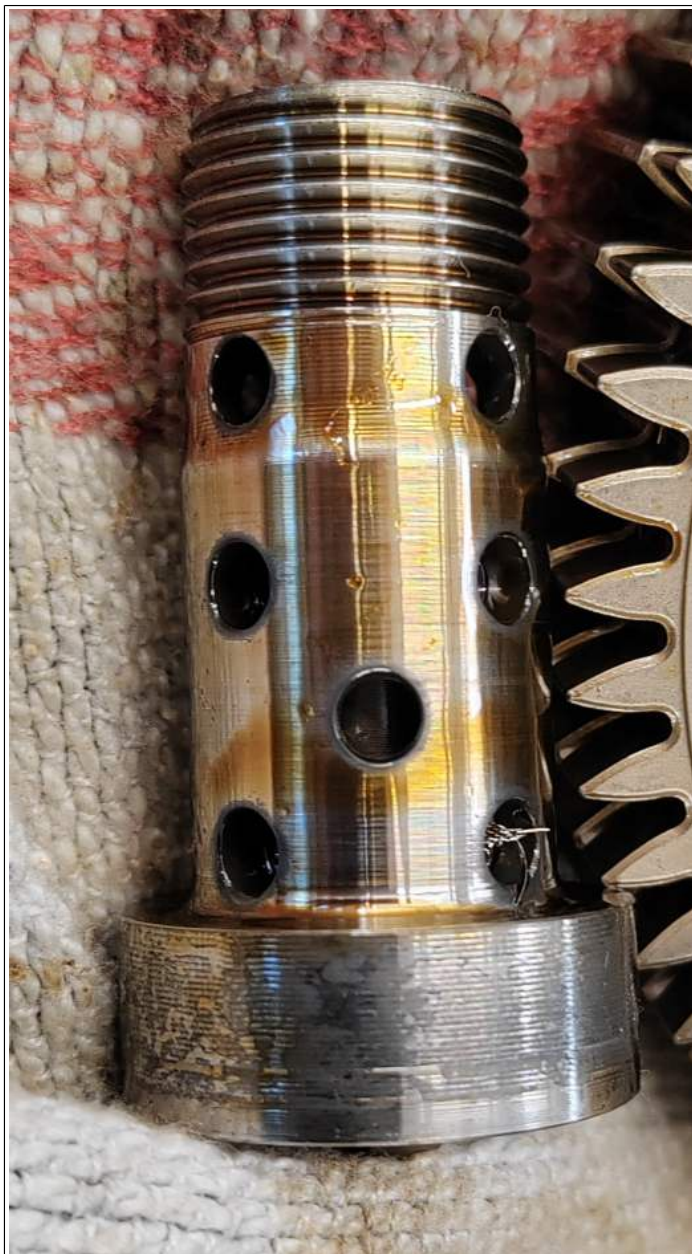
Fehlendes Sieb des Zentralventils.jpg
