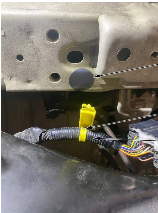
30 mm DOOR HOLE SEAL
