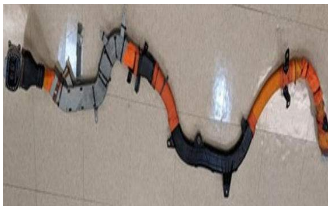
Fig. 1 HV Cable Harness
