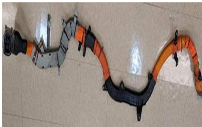
Fig. 1 HV Cable Harness
